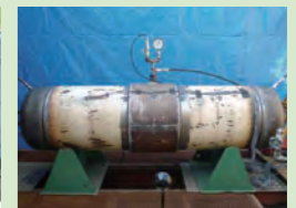
スリーブ溶接部外観
